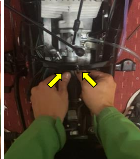
Bauteil vorn nach unten knicken
