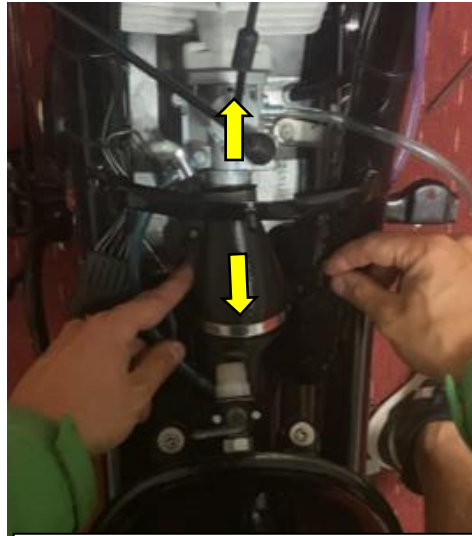
Bauteil trennen und nach hinten schieben
