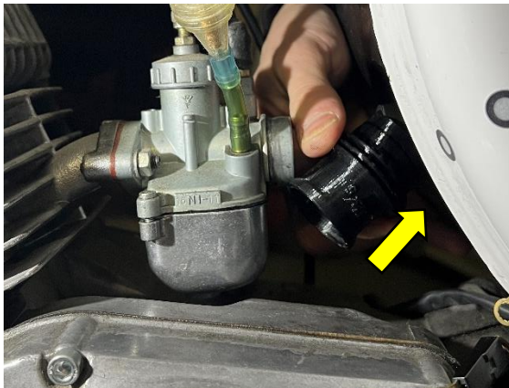
Seitlich auf Filterkastenanschluss führen und vor Vergasereingang drücken
