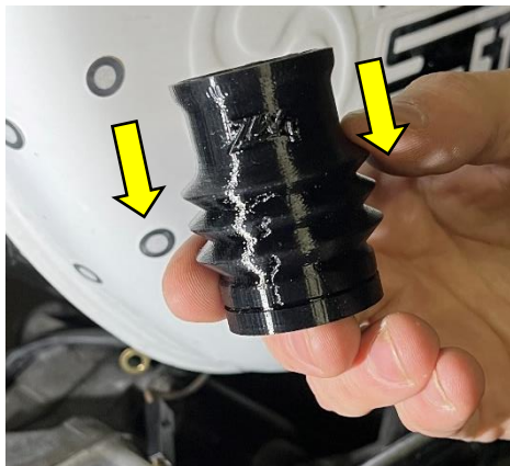
Fuge zusammendrücken um Muffe zu verkürzen
