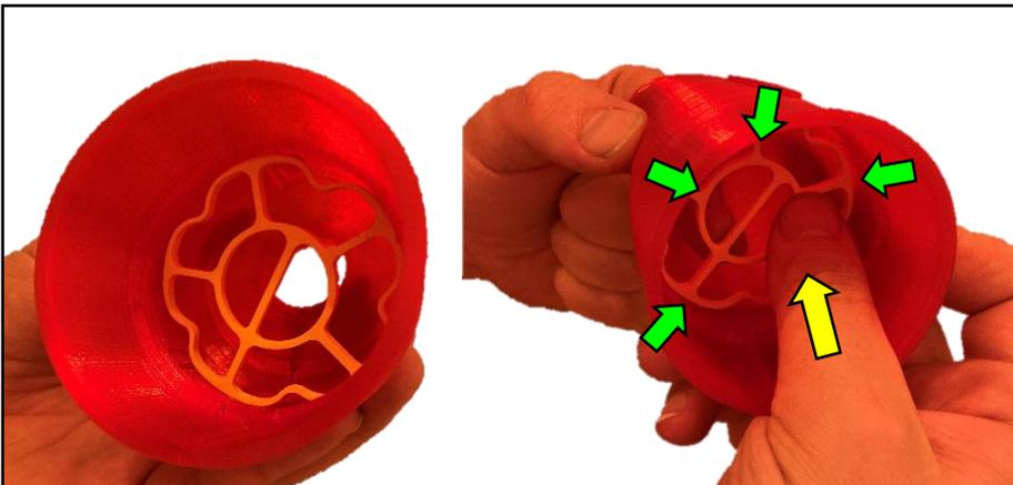
Ersten Ring schräg in die Muffe einsetzen und nach und nach alle 5 Verrastungen in die vorderste Nut drücken (am besten von vorn zusätzlich mit den Fingern führen)
