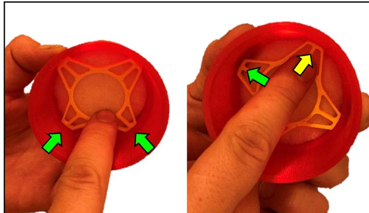
Filtermatte einlegen und danach den zweiten Ring (Stern) einsetzen. Dazu zuerst 2 Spitzen hinter den Anschlag setzen und die anderen einzeln nachdrücken
